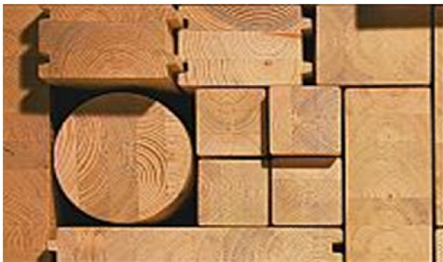
Sur la Photo 6, on voit du bois lamellé-collé, c'est-à-dire que des poutres ou des poteaux massifs ont été reconstitués à partir de pièces de sciage assemblées par collage. Les deux matériaux qui composent une pièce de lamellé-collé de ce genre sont : le bois et la colle.
