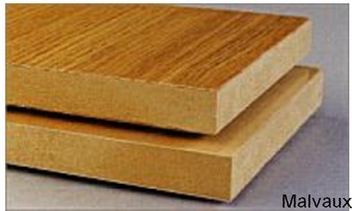
La Photo 4 montre un panneau de particules dont le centre est recouvert d'un fini ou d'une parure en mélamine. La parure aurait aussi pu être une mince couche de bois (tranché ou déroulé). C'est exactement le même principe pour le panneau de fibres imagé (Photo 5).
